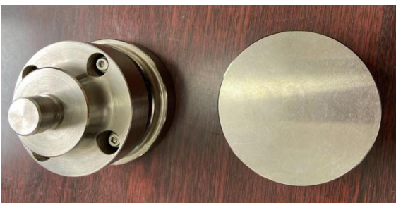
压缩样本台（直径 \leq 10\text{cm} ）
