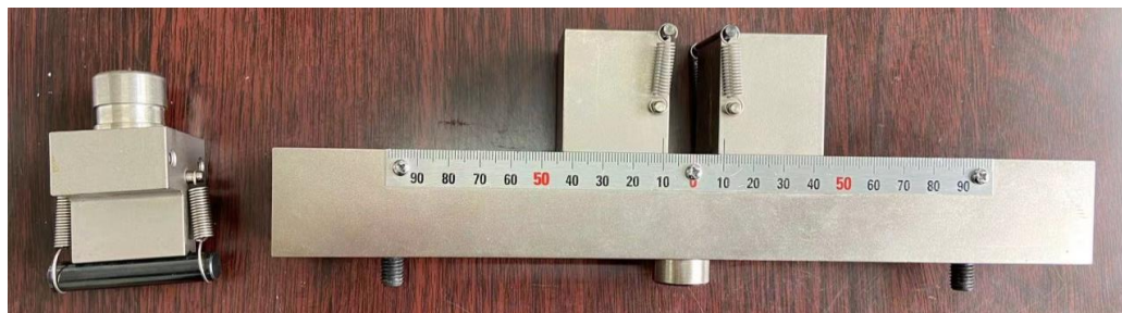
三点弯曲样本台（跨距 \leq 18\text{cm} ）
